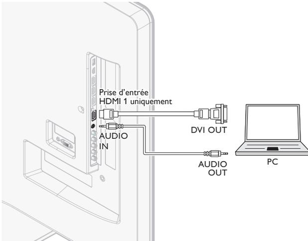
Raccordement d'un ordinateur à l'aide d'un connecteur HDMI.
