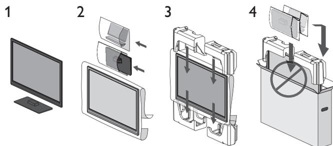
ⓘ Para evitar dano a la pantalla, no coloque la base del Televisor del lado de la pantalla.
