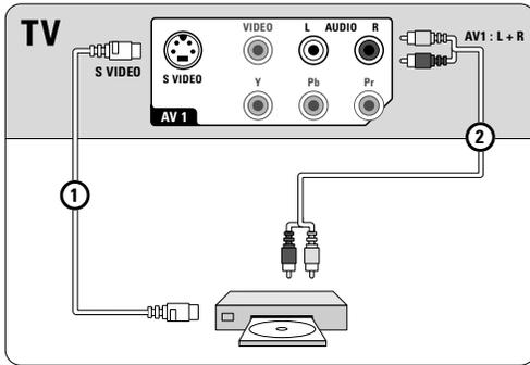
❗ Al usar el conector **S-VIDEO** no conecte ningún dispositivo a la toma de **VIDEO AV1**.
