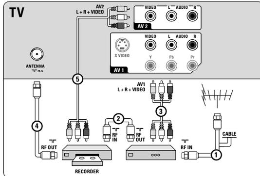
Si el grabador cuenta con toma de video S-VHS: Para una calidad superior de imagen, conecte un cable de S-video con la entrada de **S-VIDEO** y conecte los cables de audio con las tomas de entrada **AUDIO L** y **R** de **AV1**.
