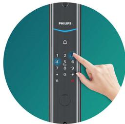
飞利浦 DDL708-VP-5HW 采用 20 位虚位密码技术, 随意输入数字组合, 确保真实密码连续输入, 即可成功识别认证。防偷窥防泄漏, 保护您的真实密码安全。
