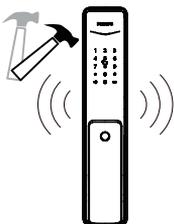
**Активация 1:** При образовании зазора между замком и ответной планкой. **Сигнал:** непрерывно повторяющиеся сигналы тревоги.
