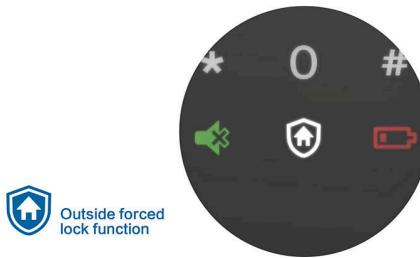
Antes de salir de casa, puede tocar el botón de bloqueo forzado exterior para activar la función. En este modo, abrir la puerta desde el interior activará una alerta. Esta función puede recordarle eficazmente los riesgos de seguridad y actualizar el nivel de seguridad del hogar.
