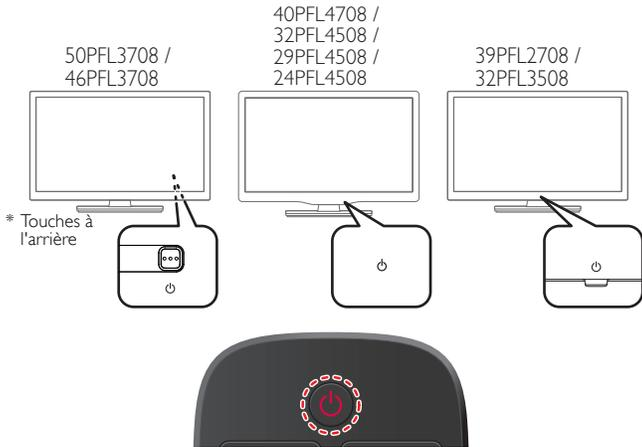
Pour allumer le téléviseur à partir du mode de mise en veille ou pour le mettre en veille
