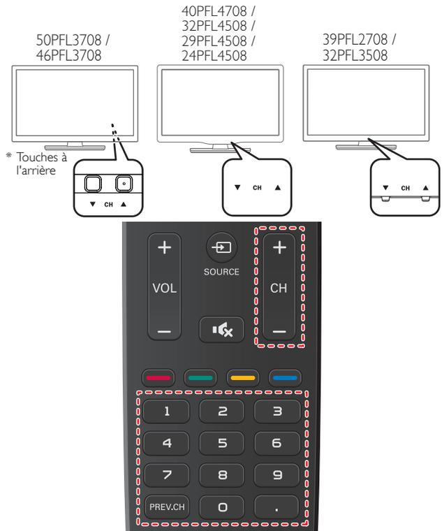
Pour sélectionner les chaînes à l'aide de **CH** / ou **CH + / -**
