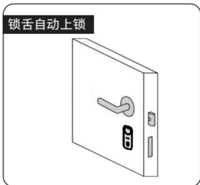
1、设置自动上锁且搭配门磁情况下，关门后，锁舌将自动打出实现上锁；
