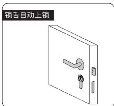
1、设置自动上锁且搭配门磁情况下，关门后，锁舌将自动打出实现上锁；
