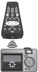
1. Dirigez l'émetteur IR de la télécommande vers la lentille de l'appareil photo numérique (ou appareil photo de téléphone cellulaire).
