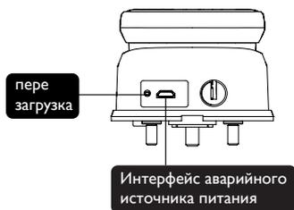
Когда заряда батареи недостаточно и дверцу невозможно открыть снаружи, вы можете включить замок через интерфейс Micro USB, используя блок питания 5V в качестве источника аварийного питания. После открытия дверного замка немедленно замените батарейки. В случае сбоя системы и невозможности открыть дверь снаружи, нажмите кнопку [RES], а затем отпустите ее для автоматической перезагрузки. Как заменить батареи Батарейный отсек
