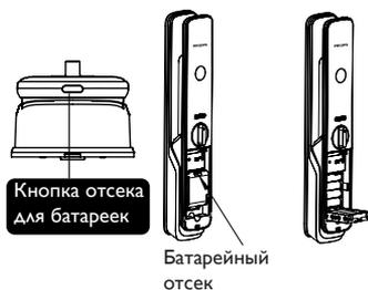
Питание замка осуществляется от четырех щелочных батареек по 1,5В. В аккумуляторном отсеке два комплекта рабочих электростанций. Можно вставить восемь батарей, чтобы продлить срок службы батарей и снизить частоту замены батарей.
