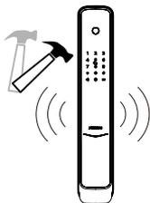
**Активация 1:** При образовании зазора между замком и ответной планкой. Сигнал: непрерывно повторяющиеся сигналы тревоги.
