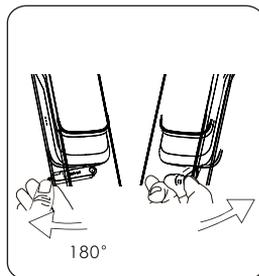
③ Поверните корпус ключа вниз на  $180^\circ$ , чтобы он был параллелен земле. Затем поверните его горизонтально по направлению к ручке, чтобы открыть дверь.
