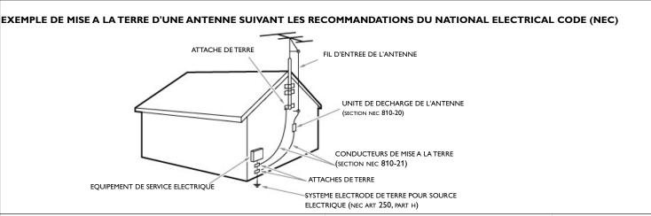
Remarque pour les installateurs de système de câble : Ce rappel s'adresse aux installateurs de système de câble afin d'attirer leur attention sur l'article 820-40 du code NEC qui indique la marche à suivre pour une mise à la terre adéquate et, en particulier, spécifie que le câble de masse doit être raccordé au système de mise à la terre du bâtiment, aussi près que possible du point d'entrée du câble.
