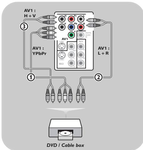
1. Conecte el dispositivo con salida RGB con sincronización Horizontal y Vertical separadas a las tomas de entrada **Pr/R, Pb/B e Y/G** **1** y a las tomas **H y V** de **AV1** **2**.
