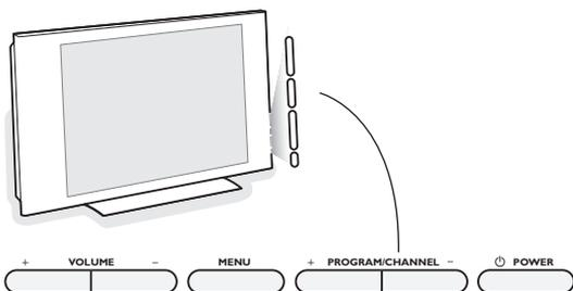
Si el control remoto se rompe o extravía, siempre será posible modificar determinados ajustes básicos con los botones de la parte derecha del televisor. Pulse el interruptor de alimentación
