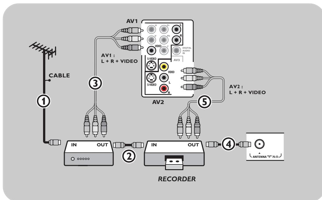
1. Conecte el cable de antena de RF ① de la toma de **entrada de RF** del otro dispositivo de AV.
