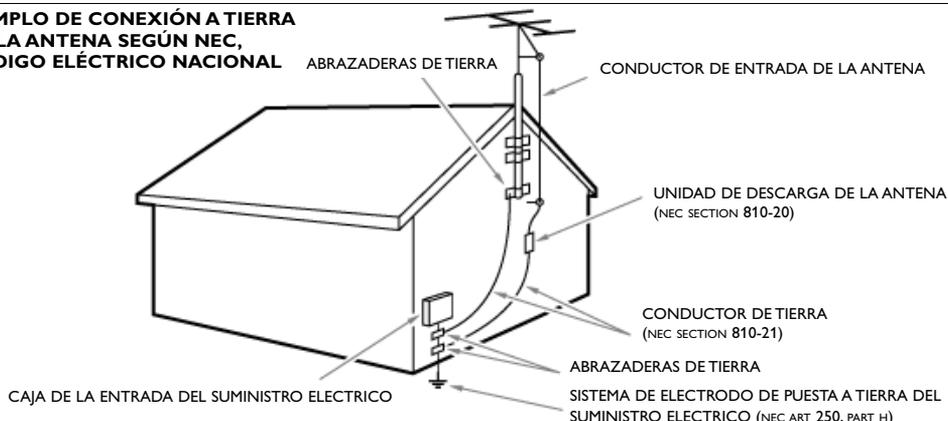
**Nota para el instalador del sistema CATV:** Se hace este recordatorio para llamar la atención del instalador del sistema de CATV sobre el Artículo 820-40 de donde se proporcionan instrucciones para la apropiada conexión a tierra y, en particular, se especifica que la tierra de los cables se conectará al sistema de conexión a tierra del edificio tan cerca del punto de entrada como sea posible.
