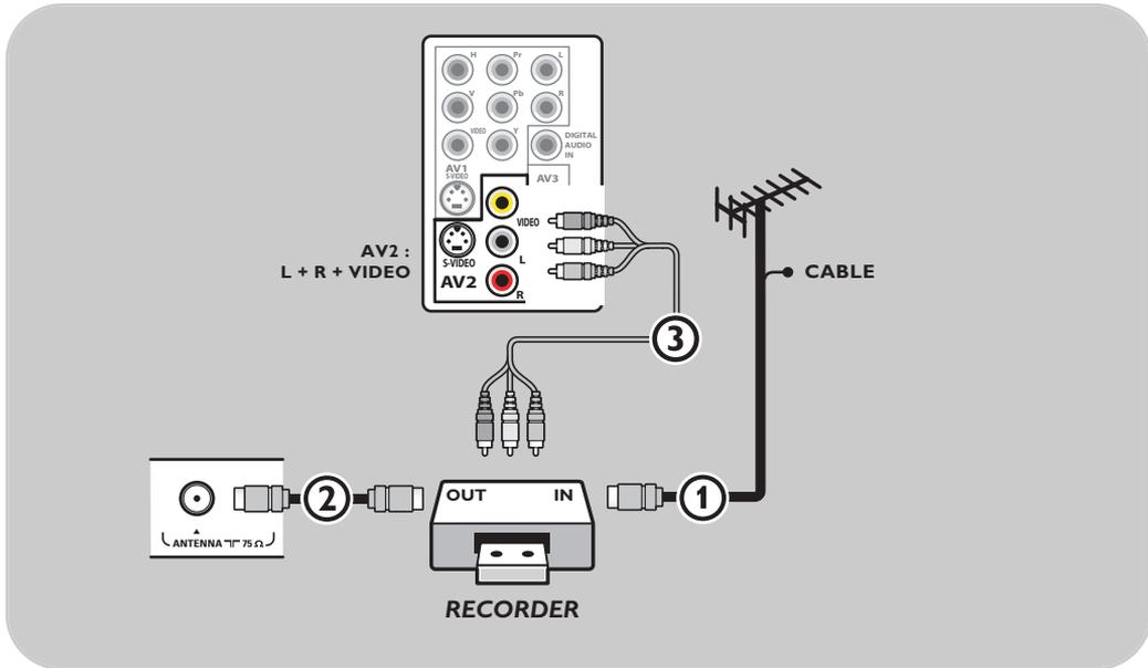
1. Conecte la antena RF o el cable de TV por Cable (puede utilizar un divisor de señales bidireccional opcional y/o una caja de convertidor de TV por cable) ① a la toma de entrada de **RF** del grabador.
