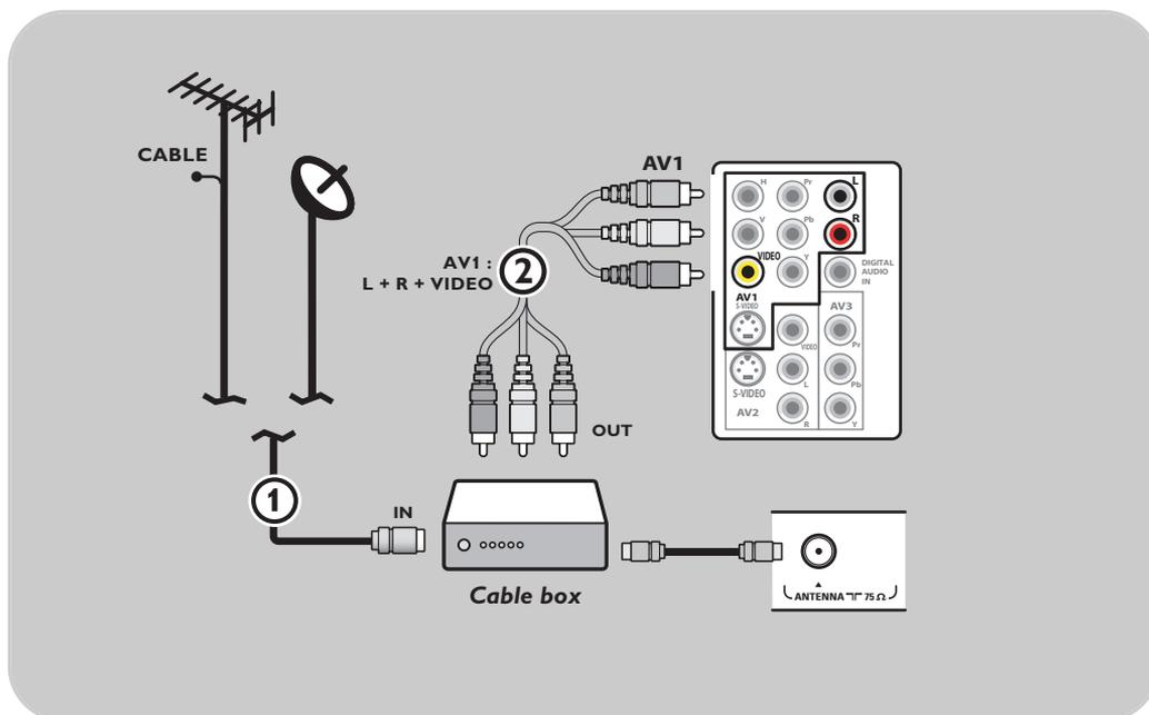
1. Conecte el cable de antena satelital o el cable de TV por cable ① a la toma de **ENTRADA** del receptor satelital o de la caja de cable.
