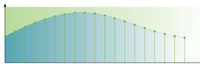
El muestreo a 192 KHz permite obtener una representación precisa de las curvas de sonido originales. En combinación con una resolución de 24 bits, se captura más información de la forma de onda del sonido analógico original y se consigue una reproducción de audio de mayor calidad.
