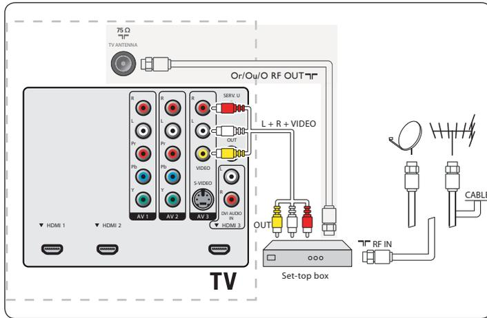
Si votre appareil est doté d'une prise vidéo S-VHS : pour améliorer la qualité de l'image, branchez un câble S-Video dans l'entrée S-Video et branchez les câbles audio dans les prises d'entrée audio L et R de l'AV3 ou du AV (côté).
