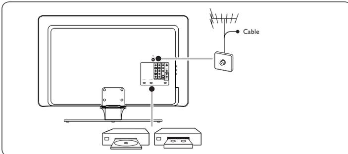
Utilisez les connecteurs arrière du téléviseur pour brancher l'antenne ou le câble et pour raccorder des périphériques permanents tels
