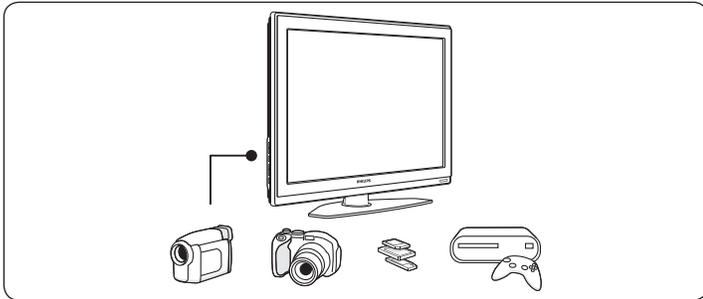
Utilisez les connecteurs latéraux pour brancher des appareils mobiles comme un appareil photo ou une console de jeux haute définition. Vous pouvez également raccorder une casque d'écoute ou un dispositif à mémoire USB.
