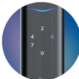
Технология имитации PIN-кода в умном замке Philips EasyKey Alpha позволяет вводить любые комбинации случайных чисел для успешной идентификации при условии последующего ввода реального пароля. Эта функция позволяет предотвратить возможность подглядывания посторонним человеком и защитить ваш настоящий пароль.
