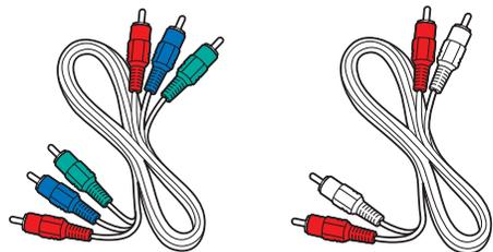
Prend en charge les signaux analogiques de haute définition, mais la qualité de l'image est inférieure à celle offerte par la norme HDMI. Les Composantes des câbles Vidéo (Y/Pb/Pr) combinent des câbles vidéos rouges, verts, bleus avec des câbles audio (G/D) rouges, blancs. Faites correspondre la couleur des câbles à celle des connecteurs du téléviseur.
