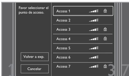
5. Aparecerá la pantalla “Configuración de Punto de Acceso (Exploración automática)”. Ingrese la clave WEP / WPA de la red Wi-Fi seleccionada mediante los botones del cursor, botones numéricos y teclas de color, y luego pulse [Rojo].
