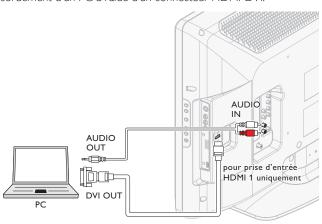
Raccordement d'un PC à l'aide d'un connecteur HDMI.
