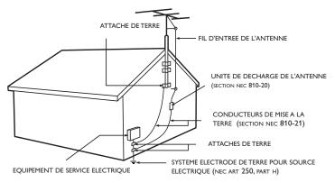
Remarque pour les installateurs de système de câble: Ce rappel s'adresse aux installateurs de système de câble afin d'attirer leur attention sur l'article 820-40 du code NEC qui indique la marche à suivre pour une mise à la terre adéquate et, en particulier, spécifie que le câble de masse doit être raccordé au système de mise à la terre du bâtiment, aussi près que possible du point d'entrée du câble.
