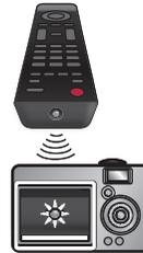
p. ej.) Con una Cámara Digital: Apunte la cámara Digital hacia el diodo infrarrojo del control remoto en el frente del control remoto. Presione y sostenga cualquier Tecla sobre el Control remoto y vea en la pantalla de la cámara. Si la luz infrarroja pulsátil aparece en la cámara, el mando a distancia está emitiendo una señal IR.
