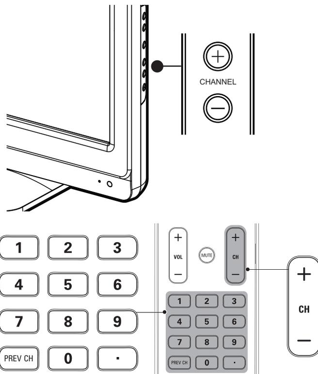
Presione **CHANNEL +/-** en el costado de la TV. Para canales digitales, pulse un número (de 1 a 135) seguido de un punto “.” y, a continuación, el número del subcanal correspondiente (de 1 a 135). p. ej. 108.30.
