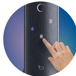
飞利浦易锁采用虚位密码技术，您可随机输入数字组合，只要其中包含连续输入的真实密码，就可成功识别。此功能可有效防止偷窥，保护您的真实密码安全。
