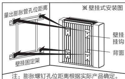
注：壁挂安装时机体不能装上脚板和脚轮；安装高度最低不能低于150mm
