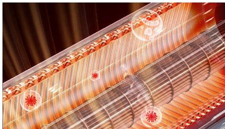
在机芯智能水洗完成后，57 °C 高温除菌模块可对蒸发器进行烘干，并进一步除菌，
