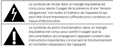
Le symbole de l'éclair dans un triangle équilatéral est conçu pour alerter l'utilisateur de la présence d'une "tension dangereuse" non isolée à l'intérieur de l'appareil et qui peut être d'une importance suffisante pour constituer un risque d'électrocution.
