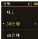
注：设定定时录音时，在关机状态一定要保证机器电源开关在 ON 位置，否则定时录音时间到时，无法执行定时录音。
