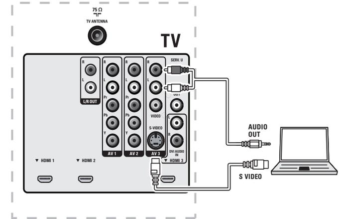
Raccordement d'un ordinateur à l'aide d'un connecteur S-Vidéo situé à l'arrière
