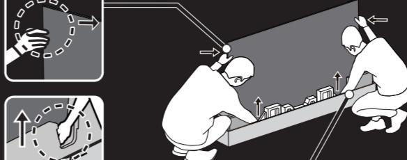
4 竖直移动屏幕，确保平整台面上无杂物后铺上软布，屏幕朝下平放在桌上。
