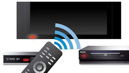
EasyLink использует протокол промышленного стандарта HDMI CEC для объединения функций телевизора и подключенных устройств. Благодаря технологии EasyLink для управления основными функциями телевизора и подключенных к нему устройств достаточно одного пульта ДУ. EasyLink использует стандартный кабель HDMI для передачи системных команд. Эта технология работает со всеми электронными устройствами с поддержкой HDMI CEC.
