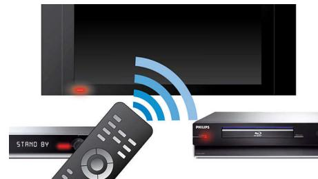
EasyLink, fonksiyonları bağlı cihazlar ve TV arasında paylaşmak için HDMI CEC endüstri standarı protokolünü kullanır. Easylink ile, TV'nizdeki ve bağlı cihazlardaki ana fonksiyonları çalışırmak için sadece uzaktan kumanda gereklidir. EasyLink, sistem komutlarını aktarmak için standart HDMI kablosu kullanır. HDMI CEC ile donatılmış tüm elektronik cihazlar arasında çalışır.
