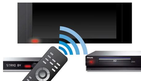
O EasyLink usa o protocolo padrão da indústria HDMI CEC para compartilhar a funcionalidade entre dispositivos conectados e a TV. Com o Easylink somente um controle remoto será necessário para operar as funcionalidades principais da TV e dos dispositivos conectados. O EasyLink usa o cabo de HDMI padrão para transferir comandos do sistema. Ele funciona com todos os dispositivos eletrônicos equipados com HDMI CEC.
