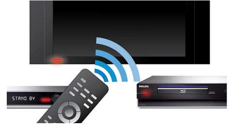
EasyLink utilizza il protocollo standard del settore HDMI CEC per la condivisione delle funzionalità tra i dispositivi collegati e il televisore. Grazie a EasyLink è necessario un solo telecomando per controllare le principali funzionalità del televisore e dei dispositivi collegati. Per il trasferimento dei comandi di sistema, EasyLink utilizza il cavo HDMI standard e funziona con tutti i dispositivi elettronici dotati di sistema HDMI CEC.
