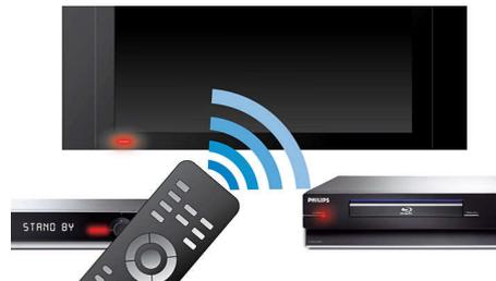
EasyLink utilise le protocole standard HDMI CEC pour partager les fonctionnalités entre les appareils connectés et le téléviseur. Avec EasyLink, une seule télécommande suffit pour utiliser les fonctionnalités principales de votre téléviseur et des appareils connectés. EasyLink utilise un câble HDMI standard pour transférer les commandes du système. Cela fonctionne avec tous les appareils électroniques équipés de la technologie HDMI CEC.
