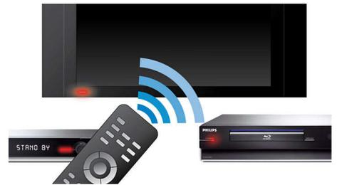
EasyLink utiliza el protocolo HDMI CEC estándar del sector para compartir funciones entre los dispositivos conectados y el televisor. Con EasyLink solo se necesita un mando a distancia para utilizar las principales funciones del televisor y los dispositivos conectados. EasyLink utiliza el cable HDMI estándar para transferir comandos del sistema. Funciona entre todos los dispositivos electrónicos equipados con HDMI CEC.
