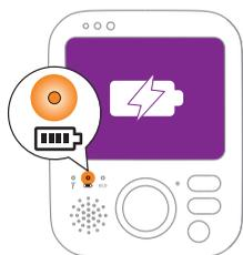
Remarque : Lorsque l'unité parent est éteinte et que l'adaptateur secteur est branché sur celle-ci, l'écran s'allume et l'icône de charge apparaît sur l'écran pour indiquer que l'appareil est en charge. Après 5 secondes, l'écran s'éteint.
