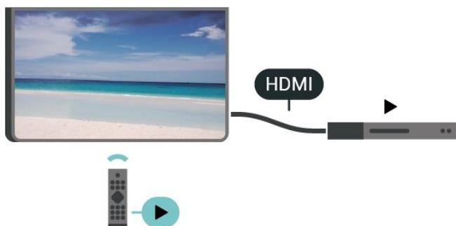
L'option HDMI CEC (Consumer Electronic Control) doit être activée sur le téléviseur et l'appareil connecté.
