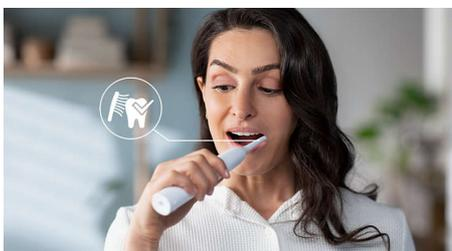
El sensor de presión integrado detecta automáticamente la presión que se aplica, te avisa y reduce las vibraciones del cepillo dental automáticamente para ayudar a proteger las encías. El cepillo dental emitirá un sonido intermitente para recordarte que debes reducir la presión. Siete de cada 10 personas opinan que esta función les ha ayudado a cepillarse mejor.
