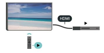
O HDMI CEC (Consumer Electronic Control, controle eletrônico do consumidor) deve estar ligado na TV e no dispositivo conectado.
