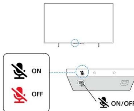
Қашықтан басқарылатын микрофонның астында қосқыш түймесі бар, микрофонды қосу немесе өшіру үшін соны басуға болады. Әдетте микрофон дайын күйде, ал LED индикатор шамы өшірулі болады. Қосқыш түймесін басу арқылы микрофон өшірілсе, микрофонның дайын емес екенін еске салу үшін LED индикатор шамы жанады.
