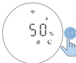
**Modo Sono (🌙):** o aparelho funciona silenciosamente a uma velocidade reduzida. Depois de 3 segundos, o ecrã desliga-se.
