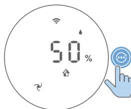
**Velocidade da ventoinha 1 e 2 (🌀 e 🌀):** no modo manual, o aparelho funciona na velocidade 1 ou na velocidade 2.
