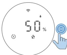
**Modo Automático (A):** o purificador de ar ajusta automaticamente a velocidade da ventoinha de acordo com a qualidade do ar ambiente.
