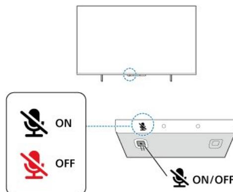
Có một nút công tắc bên dưới Micrô trường xa, bạn có thể nhấn nút để bật hoặc tắt micrô. Thông thường, micrô sẽ ở trạng thái sẵn sàng và đèn báo LED tắt. Nếu micrô bị tắt bằng cách nhấn nút công tắc, đèn báo LED sẽ bật sáng để nhắc bạn rằng micrô chưa sẵn sàng.
