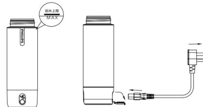
通电: 接入电源进入待机状态, 发出一声“滴”, 同时按键亮蓝光, 15秒后显示实时温度, 如果1分钟内无操作, 则进入待机模式按键被锁定, 长按按键2秒即可解除待机模式。
