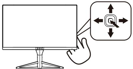
Um das Bildschirmmenü auf diesem Philips-Monitor aufzurufen, verwenden Sie die Umschalttaste an der Rückseite des Monitorrahmens. Diese Taste funktioniert wie ein Joystick. Um den Cursor zu bewegen, bewegen Sie die Taste in vier Richtungen. Drücken Sie die Taste, um die gewünschte Option zu wählen.
