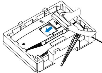
3. Richten Sie den Monitor nach Anbringung der Ständer auf, indem Sie ihn mit beiden Händen sicher gemeinsam mit dem Styropor greifen. Nun können Sie das Styropor herausziehen. Beachten Sie, dass dieser Monitor ein gewölbtes Design besitzt. Drücken Sie den Bildschirm beim Herausziehen des Styropors nicht zusammen. Andernfalls könnte er beschädigt werden.
