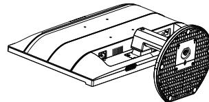
2. Îndepărtați șuruburile din stativ.
