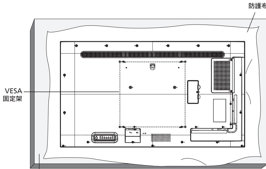
1. 顯示器擺放在平坦表面上時展開包覆顯示器的防護布。讓顯示器正面朝下放置在防護布上，以協助您操作而不會刮傷螢幕。
