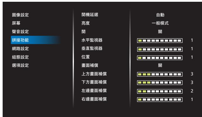
本功能可建立一個大型螢幕矩陣（電視牆），最多可由 150 部顯示器組成（垂直最多 10 部，且水平最多 15 部）。本功能需使用菊鍵法連接。
