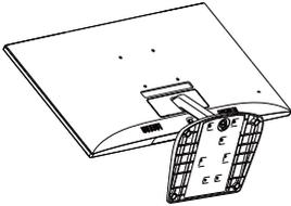
2. Bruk fingrene dine til å løsne skruen nederst på basen, og ta basen av stativet.
