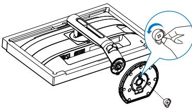
3. Stlačte a podržte uvoľňovacie tlačidlo a stojan nakloňte a vysuňte ho.
