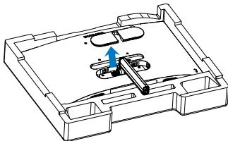
4. Викрутіть гвинти з тримача за допомогою викрутки та від'єднайте тримач/підставку від монітора.
