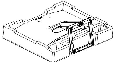
2. За допомогою викрутки відкрутіть гвинт, розташований на нижній панелі основи й зніміть основу з опори.
