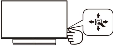
Для входа в экранное меню на этом мониторе Philips используется одна кнопка-переключатель на боковой панели монитора. Кнопка выполняет функции джойстика. Для перемещения курсора нажимайте на кнопку в четырех направлениях. Нажмите на кнопку для выбора нужного параметра.
