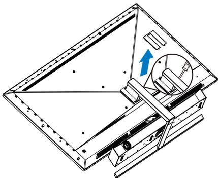
2. Ослабьте установочные винты, а затем отсоедините основание от монитора.
