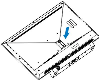
4. Из-за конструкции задней панели монитора перед установкой кронштейна для настенного монтажа обязательно затяните 4 распорные гайки (входят в комплект). Над крышкой петель.
