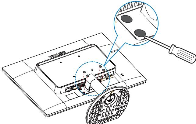
3. Вийміть гвинти з покриття петель.
