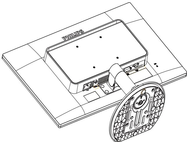
2. Пласкою викруткою вийміть чотири захисні плівки з покриття петель.
