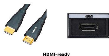
Uredaj s podrškom za HDMI ima sav potreban hardver za prihvatanje HDMI (High-Definition Multimedia Interface – multimedijsko sučelje visoke rezolucije) ulaznih signala. HDMI kabel omogućava reprodukciju vrlo kvalitetnih digitalnih video i audio signala koji se zajedno prenose jednim kabelom s računala ili bilo kojeg AV izvora (set-top box uređaja, DVD reproduktora, A/V prijemnika i kamkordera).
